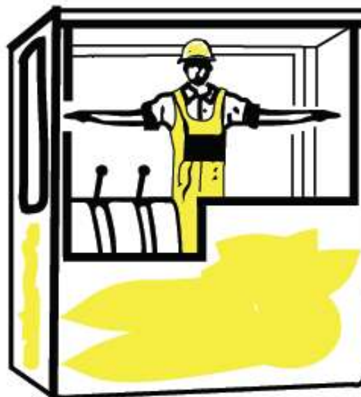
MAGNETO DESCONECTADO El operador de la grúa extiende ambas manos aparte, con las palmas hacia arriba.
